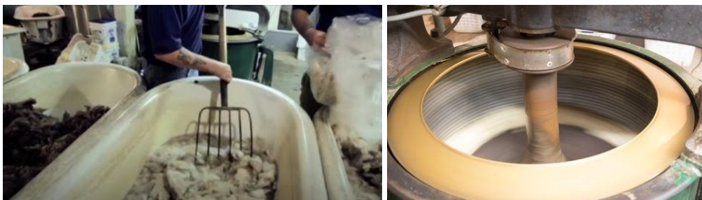
Figur 13 og 14: Håndvask og centrifugering af uld hos Frankenmuth Woolen Mill i USA. Her vaskes årligt 25 tons uld ved brug af denne metode. Slutproduktet er ulddyner.
