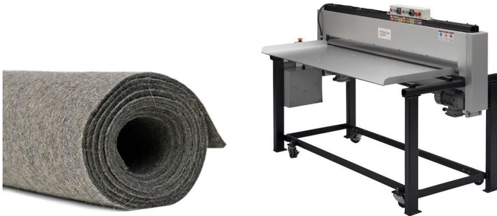
Figur 21 og 22: Oprullet 5 mm nålefilt, t.v. og FeltLoom Pro Serie, nålefiltemaskine.
