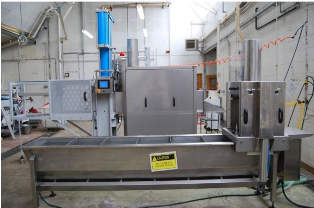
Figur 15: Vaskeanlægget (forrest) og tørreanlægget KiwiScour fra Newzealandske AgResearch.
