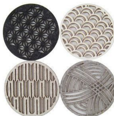
Figur 26: Eksempel på laserskårede emne i filt.
