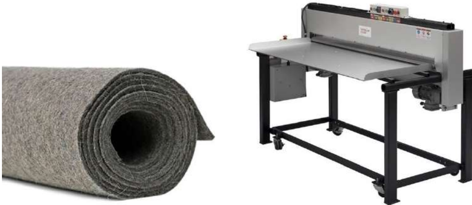
Takussutissiaq 21 aamma 22: Imusaq 5 mm nålefilter, saamerlermi aamma nålefiltermaskine FeltLoom Pro Serie.
