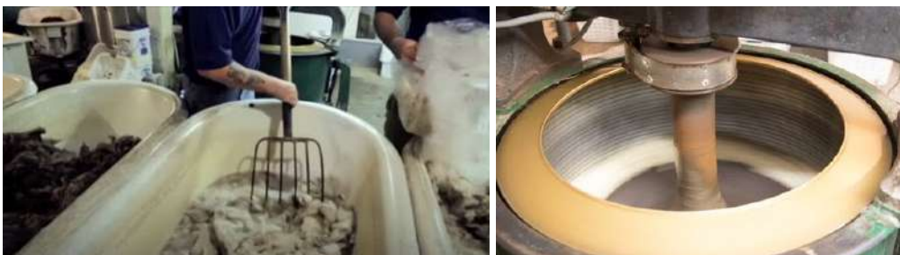
Takussutissiaq 13 aamma 14: Asaffik aamma sigguut savat meqquinut atortut Frankenmuth Woolen Mill, USA-mi. Savat meqqui 25 tons ukiumut errortorneqartarput periuseq taanna atorlugu. Tunisassiarisartagai tassaapput savat meqquinik qipiliat.
